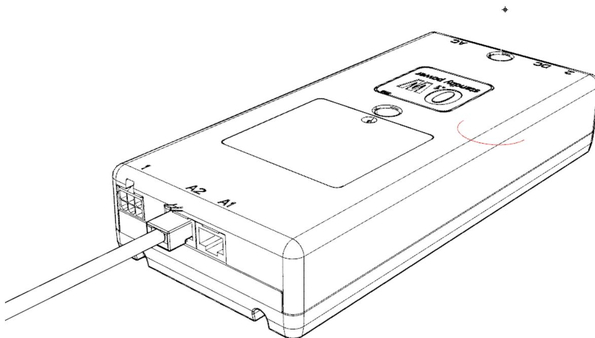
Il est possible de laisser la télécommande initiale connectée sur le second port télécommande
